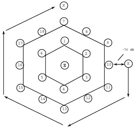
Das Gerät umrundet das Netzwerk im Uhrzeigersinn, um eine freie Position zu finden. Wenn es keine freie Position in einer bestimmten Schale findet, dann fährt es zur nördlichsten Position und eröffnet damit eine neue Schale.
