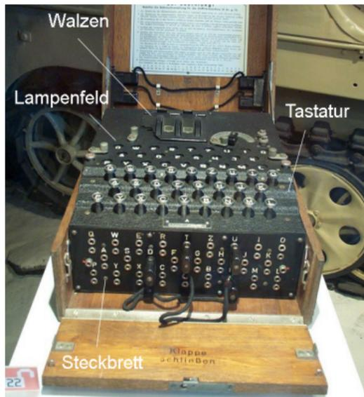
Batteriebetriebene, handliche elektrische Rotorchiffriermaschine
